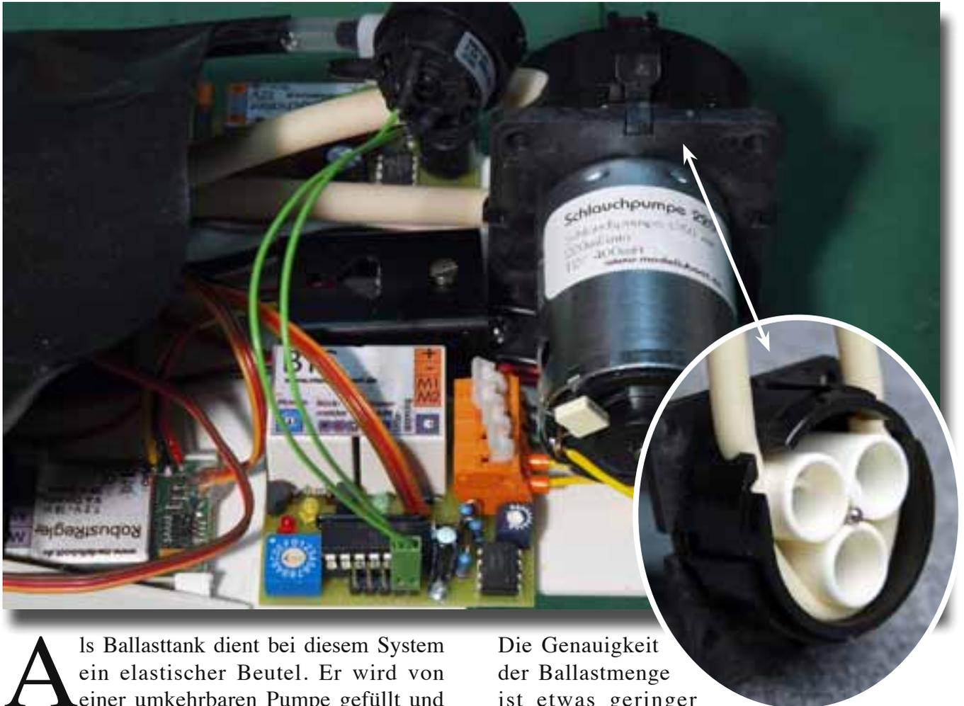
**A**ls Ballasttank dient bei diesem System ein elastischer Beutel. Er wird von einer umkehrbaren Pumpe gefüllt und gelenzt.
