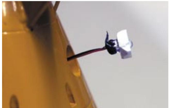
den kaptonisolierten Draht gelötet. Die Lötstellen werden mit Terostat (oder anderem Kleber) gegen Wasserkontakt geschützt.
