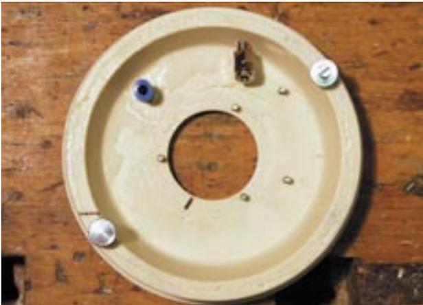
Vor allem die Position der Verriegelungsschrauben einhalten, sonst geht das Boot später nicht zu. Für die Bohrungen am Motorflansch diesen als Schablone benutzen.
